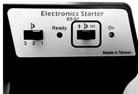
モードスイッチが中央にあるとき (Ready ランプ消灯) は、スタート音のみの出力で、レースクロックは作動しません。モードスイッチが“左”にあるとき (Ready ランプ点灯) は、スタート音とスタート信号を出力します。
